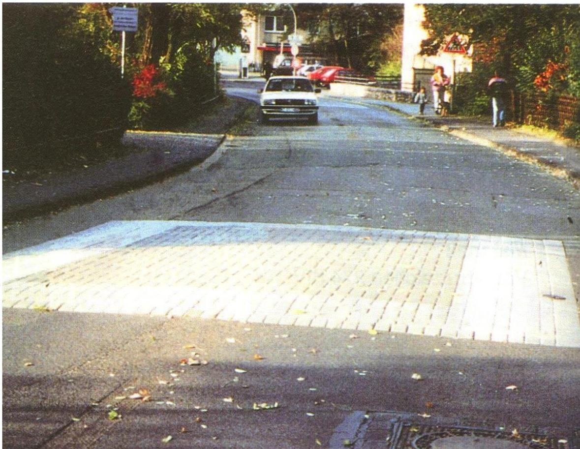
Abb. 5 - Plateauaufpflasterung (Quelle: ADAC e.V.)
