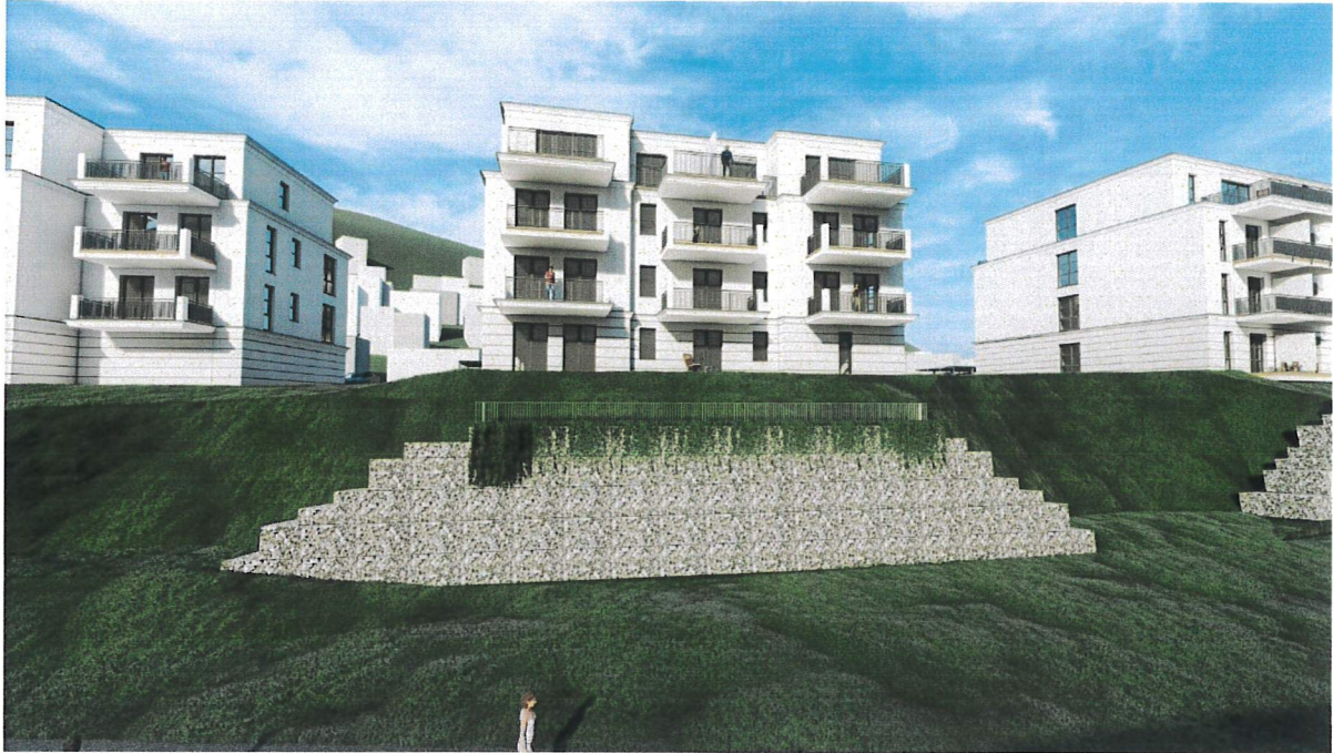
Gabionenwand Neubau – Lahnseite – Bereich Haus C (ohne Bepflanzung)
