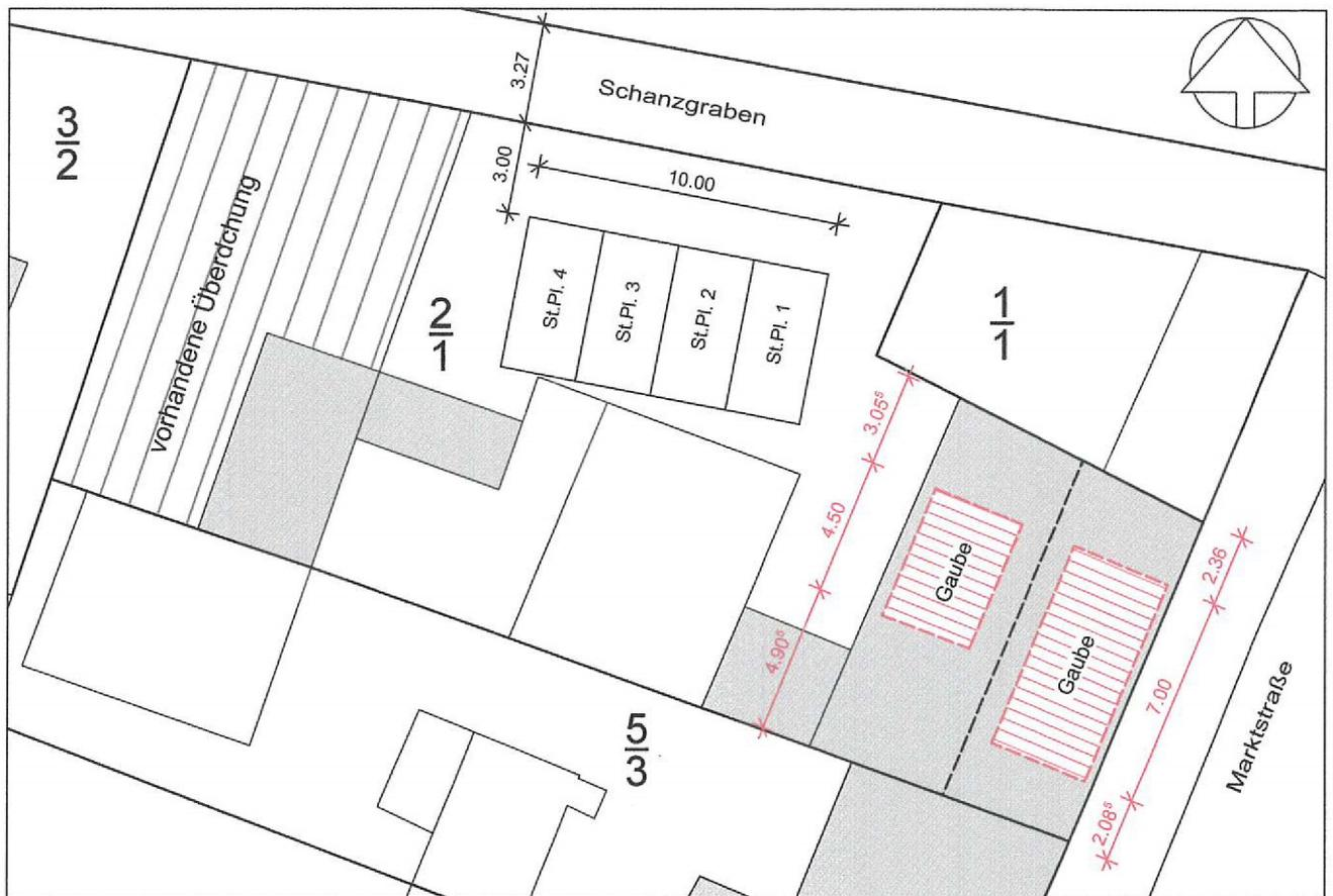
Dachhöhen am First und Traufen bleiben nach Dachstuhl-; Dacheindeckung- Erneuerung und Gaubeneinbau unverändert.
