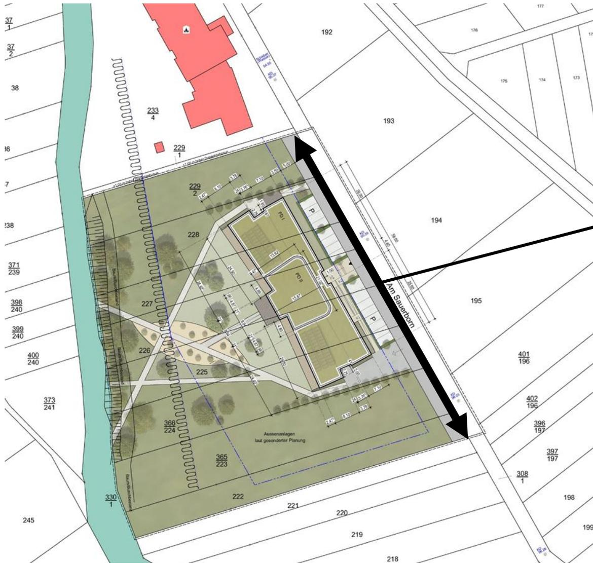
Im Rahmen der Planung werden Flächen für eine ausreichende Fahrbahnbreite für den Begegnungsfall Bus/Pkw auf einer Länge von ca. 111 m zur Verfügung gestellt.
