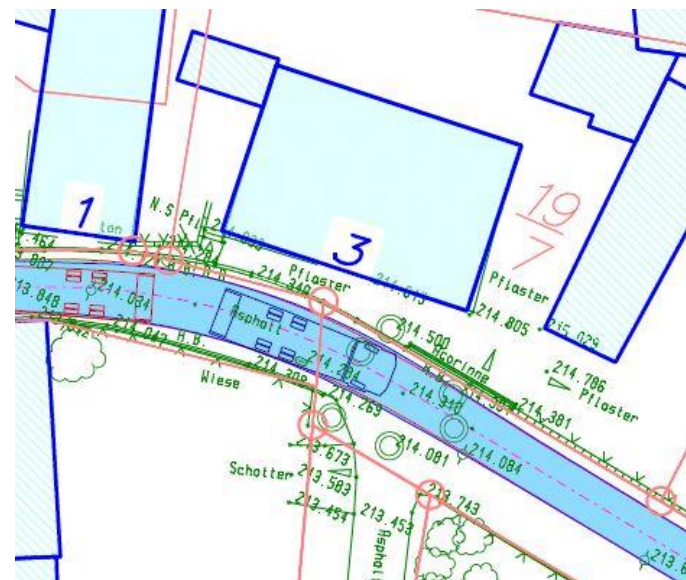
Abb.: Schleppkurve auf Höhe des Anwesens Brunnenstraße Anwesen Nr. 3 (3-achsiges Müllfahrzeug)
