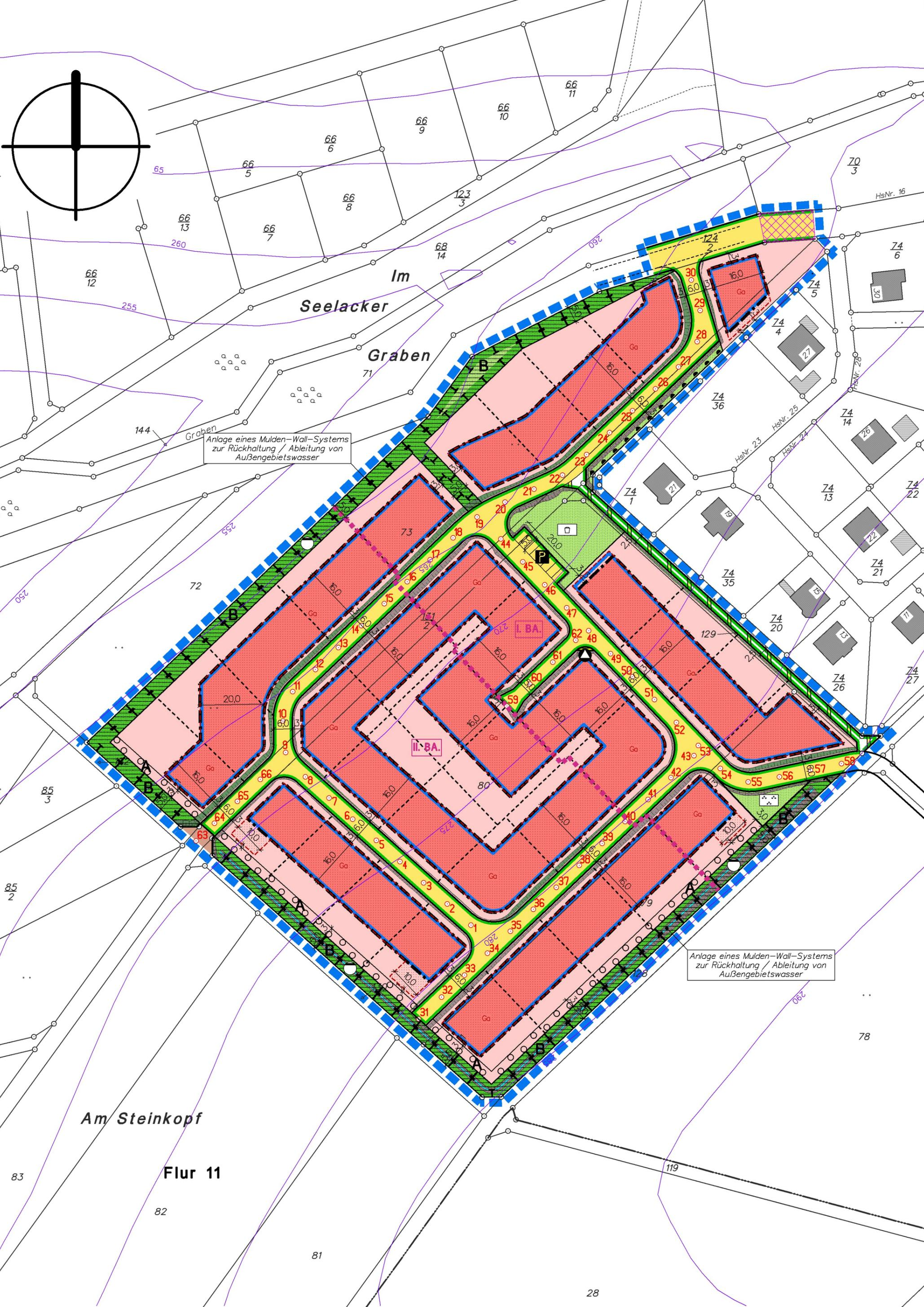
Anlage eines Mulden-Wall-Systems zur Rückhaltung / Ableitung von Außengebietswasser
