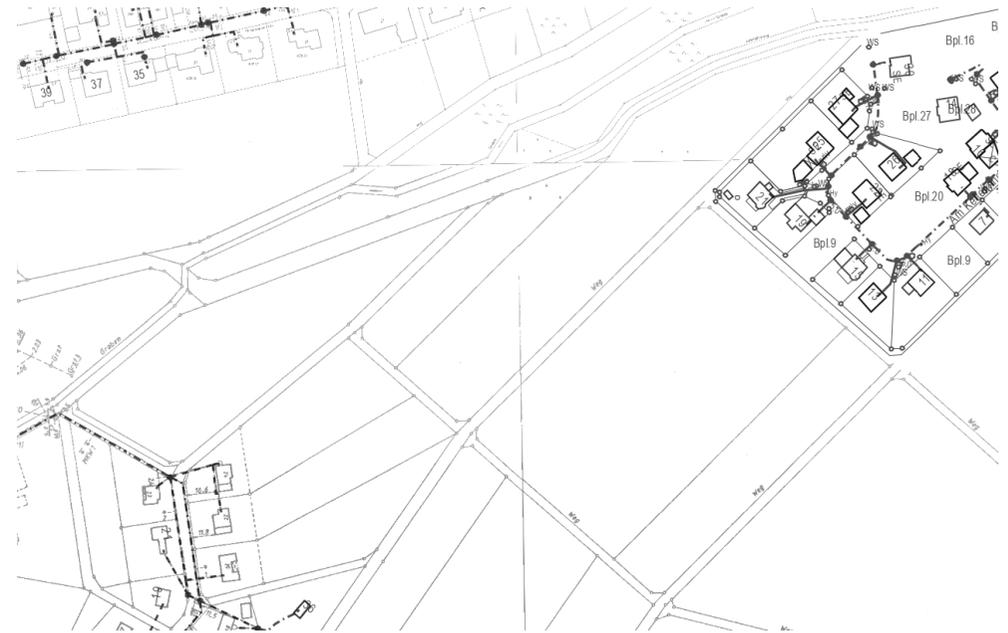
**Abb.: Lageplan zu bestehenden Leitungen im Planbereich**
