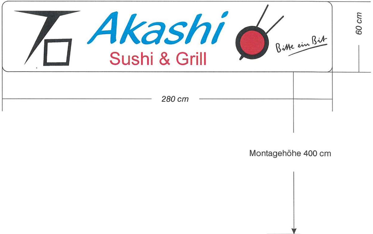
**Für den Elektroanschluss der Außen- Werbeanlagen ist bauseitig eine intakte 230 Volt Zuleitung an der Außenfassade zur Verfügung zu stellen. Eine fehlerhafte Anschlussleitung ist bauseitig zu erneuern bzw. instand zu setzen.**
